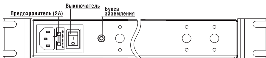
Рисунок 1. Задняя панель оптического передатчика SOT-03
